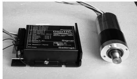
Фиг.4 BLDC EC - 4pole 30 двигател и контролер DEC 50/5 1-Q-EC (MAXON)
